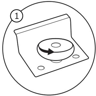
1 Déverrouiller l'abri du côté à soulever.
